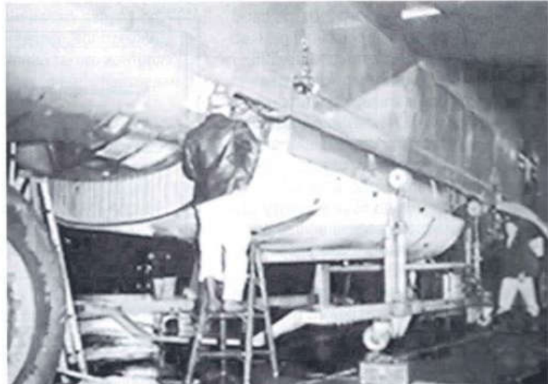
Универсальная капсула с разведывательным, помеховым и метеорологическим оборудованием и рабочими местами его операторов подвешивалась в отсек B-52 вместо вооружения
