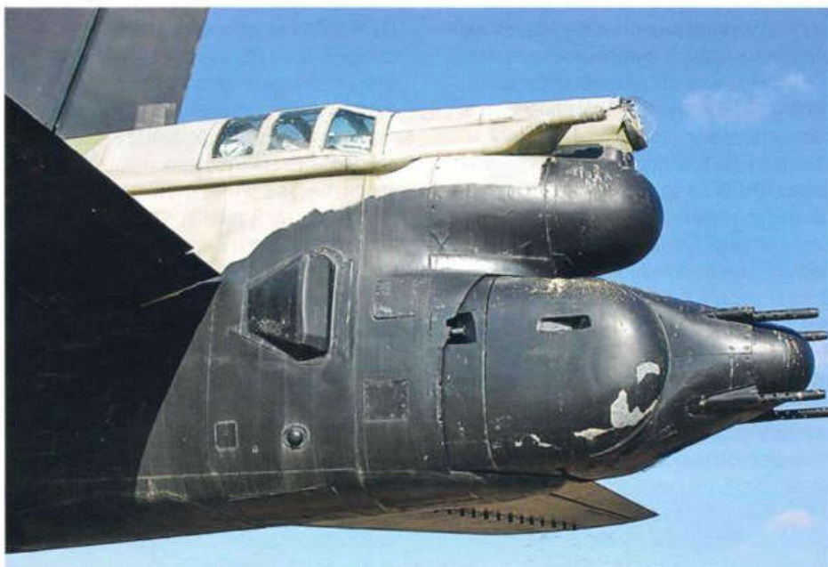
Хвостовая турель В-52 с четырьмя пулеметами М3 и системой управления огнем А-3А: телевизионный прицел в стеклянной «колбе», РЛС обнаружения целей под ним и радиолокационный прицел в подвижной части турели
