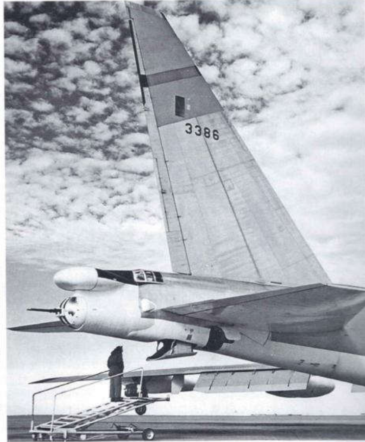
Хвостовая часть B-52B-40-BO. Люк снизу – отсек тормозного парашюта, сбоку под стабилизатором – вход в кормовую огневую точку, которая отстреливалась для аварийного покидания машины стрелком
